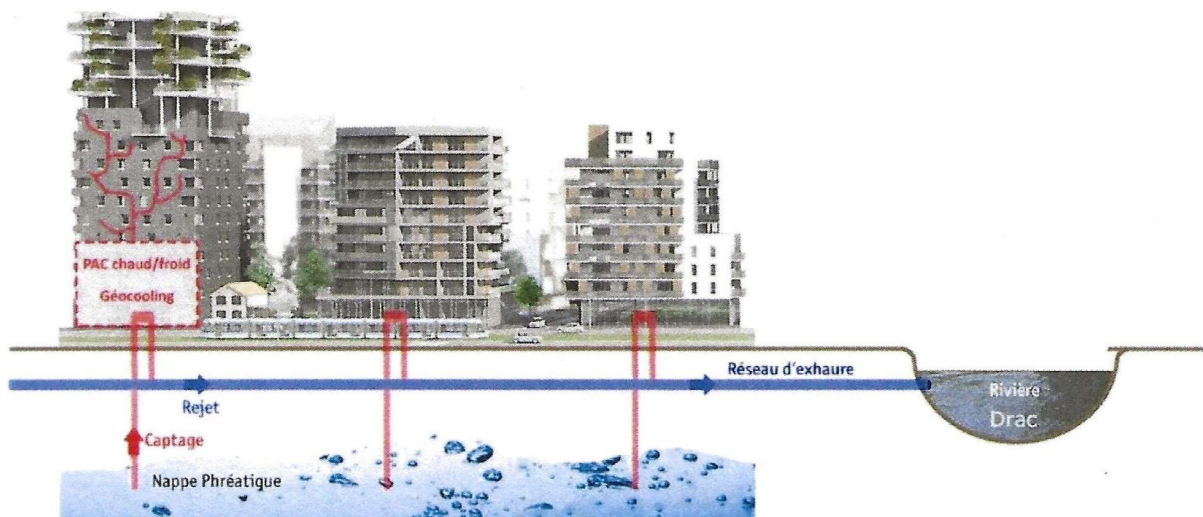
Illustration 1: Principe de fonctionnement de l'exploitation géothermique : prélèvements par forages dans la nappe phréatique, échanges thermiques vers l'immobilier, exhaure vers le Drac
